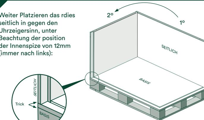
**4** Legen sie die Heftklammern aus der inneren Nut, bis Sie in den Schlitz auf der angrenzenden Seite einrastet:
